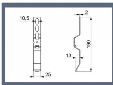
Montagebugel um ein Lintel Profil zu montieren zur Wand oder am Deckel.
